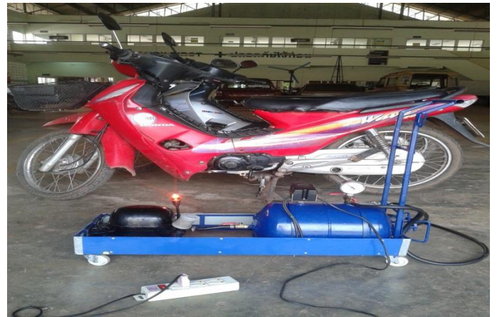
รูปที่ 5 แสดงการบรรจุลมเข้าถังเติมลมโดยเสียบไฟ 220 V เพื่อให้คอมเพรสเซอร์ทำงาน
