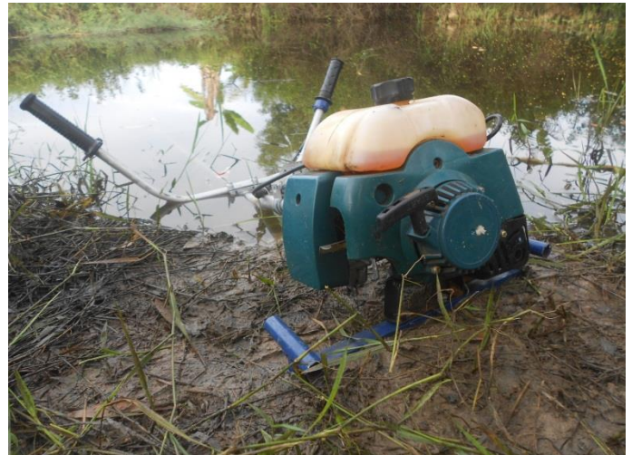
รูปที่ 5 แสดงการติดตั้งเครื่องตัดหญ้าในการสูบน้ำ
