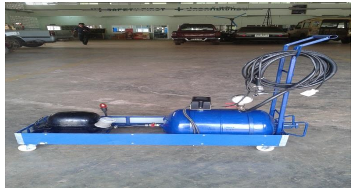
รูปที่ 4 แสดงปั๊มลมเคลื่อนที่ขนาดเล็กที่ใช้คอมเพรสเซอร์ ตู้เย็น
