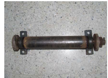
รูปที่ 3.3 แท่งแม่เหล็กทรงกระบอกยึดติดกับตุ้กดัดและพื้นเฟือง
