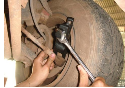
รูปที่ 4.1 แสดงการใช้เครื่องมือถอดลูกหมากปีกนกของ รถยนต์ที่ขึ้นลิฟท์
