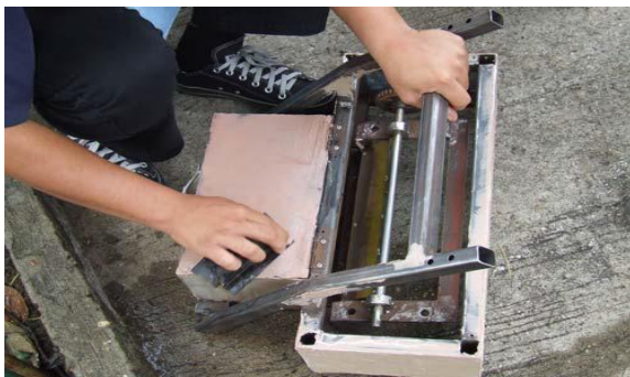
รูปที่ 3.2 โครงเครื่องดูดเศษโลหะ
