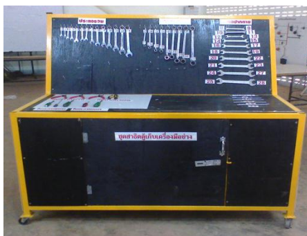
รูปที่ ๓ ชุดสาธิตตู้เก็บเครื่องมือช่าง
