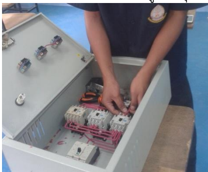
ภาพที่ ๒ ชุดฝึกควบคุมมอเตอร์แบบตู้ควบคุม
