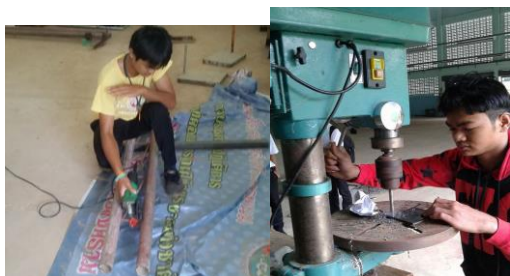
ภาพที่ ๗ การเจาะและตัดเหล็กทำโครงสร้าง
