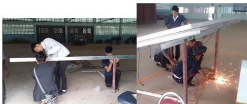
ภาพที่ ๗ การเจาะและตัดเหล็กทำโครงสร้าง
