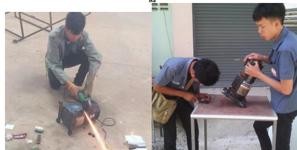
ภาพที่ ๓.๕ ตัดไม้รองฐานคอมเพรสเซอร์แอร์
