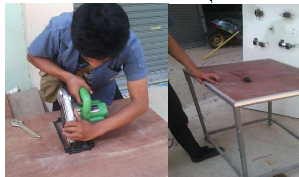
ภาพที่ ๓.๕ ตัดไม้รองฐานคอมเพรสเซอร์แอร์
