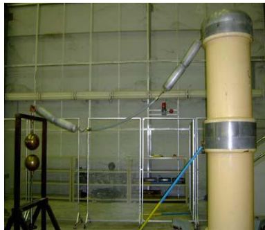
รูปที่ 8 การต่อวงจรการปรับเทียบระบบวัดแรงดันสูง
