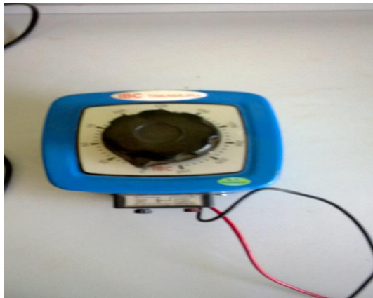
3.1.8 หม้อแปลงไฟฟ้าที่ใช้ในโครงการ ดังรูปภาพที่ 3.1.8
