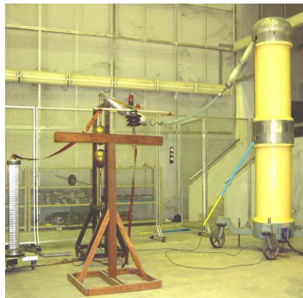
รูปที่ 9 การต่อวงจรวัดแรงดันสูงกระแสตรงด้วยช่องว่างทรงกลม
