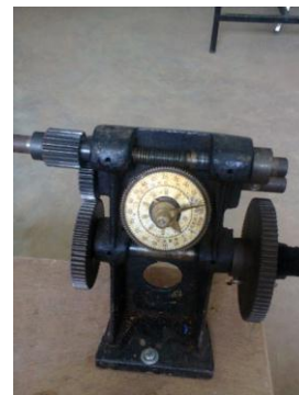
รูปที่ 3.3 ชุดพันคอยล์ในโครงการ
